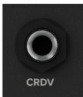
Branche le connecteur Jack 6,35 mm du contrôleur de volume CRDV dans cette prise pour ajuster à distance le volume général et celui du subwoofer.
