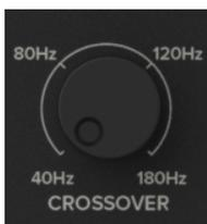
Choisis la fréquence de coupure de 40 Hz à 180 Hz pour adapter le subwoofer à tes enceintes. Ajuste ce réglage selon tes préférences.
