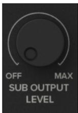
Ce potentiomètre permet de régler le volume général du subwoofer (de Off à Max). Règle le subwoofer pour équilibrer les basses selon tes préférences, puis ajuste le filtre de coupure pour obtenir le rendu souhaité.
