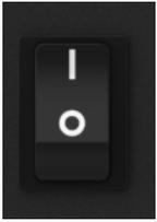
Appuie sur la partie supérieure de l'interrupteur pour mettre le subwoofer sous tension. Assure-toi avant que le potentiomètre de volume sur la face avant est au minimum (tourné complètement vers la gauche). Appuie sur la partie inférieure de l'interrupteur pour mettre le subwoofer hors tension.
