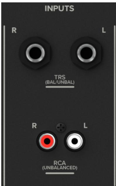
Connecte le signal de niveau ligne d'un ordinateur, d'une table de mixage, d'un smartphone, d'une tablette ou de toute autre source audio à l'une (ou plusieurs) de ces entrées. Deux types de connecteurs sont disponibles :
