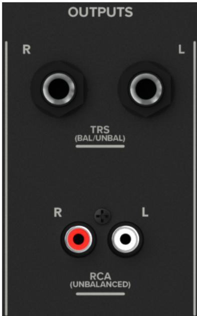
Connecte ces sorties sur les entrées des enceintes de monitoring. Comme pour les entrées, tu as le choix entre deux types de connecteurs pour les sorties gauche et droite : Jack 6,35 mm symétrique ou asymétrique ou RCA asymétrique.
