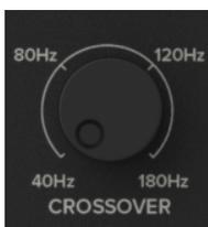
Mit dem CR8SBT-Crossover kannst du eine Trennfrequenz für Studiomonitore im Bereich von 40 Hz bis 180 Hz für einen optimalen Klang auswählen. Stelle es so ein, wie es für deine Ohren am besten klingt.
