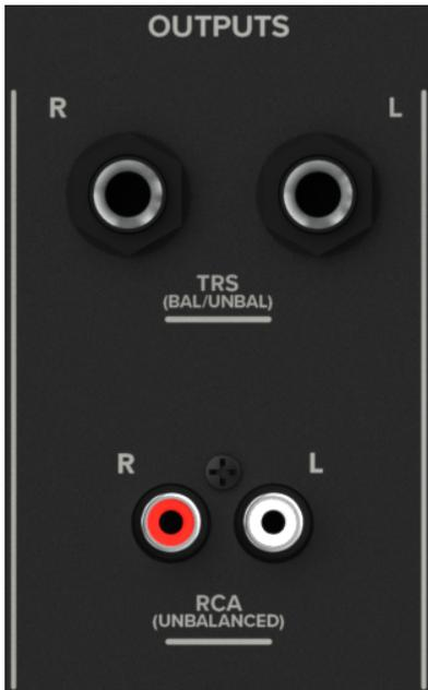
Verbinde diese Ausgangsbuchsen mit den Eingangsbuchsen der Studiomonitore. Wie bei den Eingängen gibt es auch bei den Ausgängen zwei Arten von Anschlüssen für den linken und rechten Ausgang: 6,35 mm symmetrisch oder unsymmetrisch oder unsymmetrisch Cinch.
