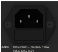
Verbinde das abnehmbare Netzkabel (im Lieferumfang des Subwoofers enthalten) mit dem Netzanschluss und stecke das andere Ende des Netzkabels in eine stromführende Steckdose.
