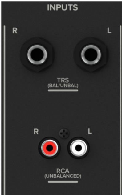
Schließe das Line-Pegel-Signal von einem Computer, Mixer, Smartphone, Tablet oder einer anderen Signalquelle an ein (oder mehrere) Paar(e) dieser Eingangsbuchsen an. Es stehen zwei Arten von Eingangsanschlüssen zur Wahl:
