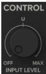
Der CR8SBT-Subwoofer erwartet ein Signal mit Line-Pegel an seinem Eingang. Mit diesem Regler kann die Empfindlichkeit der Eingangssektion (von Off bis Max) entsprechend der Signalstärke am Eingang eingestellt werden.
