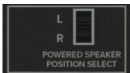
Ici, c'est toi qui choisis si le moniteur actif sera placé à gauche (sélecteur vers le haut) ou à droite (sélecteur vers le bas). L'un des avantages est d'éviter que le cordon d'alimentation et les connexions avant/arrière ne traversent ton espace de travail. De plus, cette configuration convient aussi bien aux droitiers qu'aux gauchers. Il suffit de l'adapter à tes préférences.
