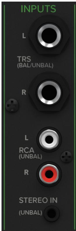
Connecte le signal de niveau ligne d'un ordinateur, d'une table de mixage, d'un smartphone, d'une tablette ou de toute autre source audio à l'une (ou plusieurs) de ces entrées. Trois types de connecteurs sont disponibles :
