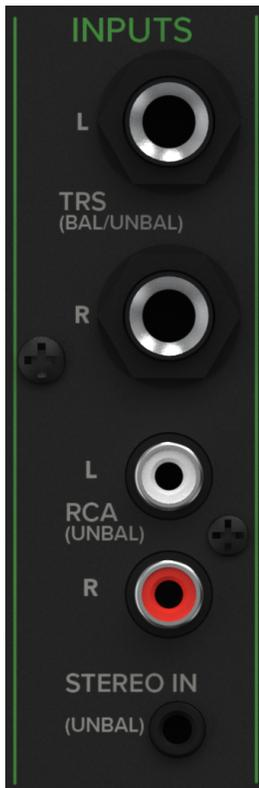
Schließe das Line-Pegel-Signal von einem Computer, Mixer, Smartphone, Tablet oder einer anderen Signalquelle an ein (oder mehrere) Paar(e) dieser Eingangsbuchsen an. Es stehen drei Arten von Eingangsanschlüssen zur Wahl:
