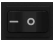
Drücke auf die linke Seite dieses Kippschalters, um die Monitore einzuschalten. Stelle sicher, dass der Lautstärkereger an der Vorderseite ausgeschaltet ist [ganz nach links gedreht], bevor du den Monitor einschaltest. Drücke auf die rechte Seite dieses Kippschalters, um die Monitore auszuschalten.
