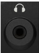
Dieser 3,5 mm TRS-Anschluss ist der Ausgang für Stereokopfhörer. Die Lautstärke wird mit dem Drehregler auf der Vorderseite des Monitors eingestellt. Das Signal zum Verstärker wird unterbrochen, wenn Kopfhörer angeschlossen sind.
