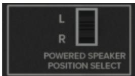
Hier kannst du entscheiden, ob der Aktivmonitor auf der linken Seite (Schalter oben) oder auf der rechten Seite (Schalter unten) positioniert werden soll. Ein Vorteil ist, dass das Netzkabel und die Anschlüsse an der Vorder- und/oder Rückseite nicht über deinen Arbeitsbereich verlaufen. Außerdem gibt es keinen Unterschied zwischen Rechts- und Linkshändlern. Stelle es einfach so ein, wie es dir am besten gefällt.
