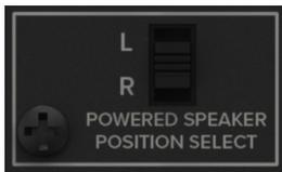
Ici, c'est toi qui choisis si le moniteur actif sera placé à gauche (sélecteur vers le haut) ou à droite (sélecteur vers le bas). L'un des avantages est d'éviter que le cordon d'alimentation et les connexions avant/arrière ne traversent ton espace de travail. De plus, cette configuration convient aussi bien aux droitiers qu'aux gauchers. Il suffit de l'adapter à tes préférences.
