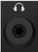
Questo connettore stereo da 3,5mm fornisce l'uscita per una cuffia stereo. La manopola **VOLUME** del pannello anteriore del monitor ne controlla il volume. Quando la cuffia è collegata all'amplificatore non arriva segnale.
