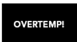
Wenn der Verstärker auf eine sichere Betriebstemperatur abgekühlt ist, setzt sich der thermische Schalter zurück und der DLM-Lautsprecher nimmt seinen normalen Betrieb wieder auf.
