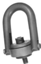
Die Nenntragfähigkeit von Schulterösen wird bei gewinkelten Aufhängungen erheblich herabgesetzt. Wenn eine Anwendung einen Montagewinkel von mehr als 45° erfordert, muss ein drehbarer Anschlagwirbel oder ein ähnliches Anschlagmittel verwendet werden. Diese Anschlagmittel sind voll dreh- und schwenkbar, so dass seitliche Belastungen vermieden werden können.
