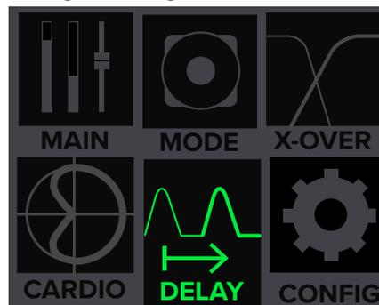
Die Delay-Zeit reicht von 0,0 ms (0 ft, 0 m) bis zum Höchstwert von 100 ms (112,5 ft, 34,2 m).
