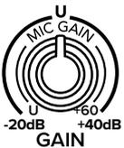
Bei Monokanälen (Mikrofoneingang mit einem Mono-Line-Eingang) stellt der Gain-Regler die Eingangsempfindlichkeit der Mikrofon- und Line-Eingänge ein.
