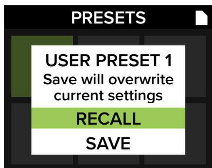
Das Drehen des Encoders wechselt zwischen "Recall" und "Save" und das Drücken des Encoders wählt die aktuell markierte Auswahl aus.
