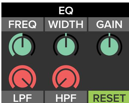
Une fois que 'Reset' est en surbrillance, appuie sur l'encodeur pour réinitialiser tous les réglages de l'EQ. C'est une façon pratique de repartir de zéro.
