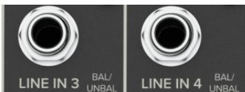
Ces entrées Jack 6,35 mm partagent le circuit des préamplis micro (mais pas l'alimentation fantôme) et acceptent des sources symétriques ou asymétriques, à pratiquement n'importe quel niveau. Tu peux y brancher quasiment tout type de signal.
