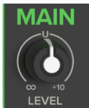
Ce réglage stéréo te permet d'ajuster le niveau du mix général envoyé vers les sorties principales symétriques XLR et les connecteurs Jack 6,35 mm niveau ligne.
