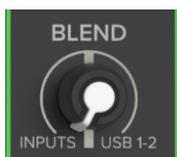
Quand l'interrupteur adjacent (To Phones / Control Room) est activé, ce réglage permet d'envoyer un mixage de toutes les entrées (sauf l'entrée minijack) et du retour USB I-2 vers les sorties casque et Control Room. Petit bonus : tout cela se fait sans aucune latence !
