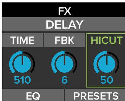
Sur la première capture à gauche, hi-cut est simplement en surbrillance. Sur celle en dessous, hi-cut a été sélectionné (en appuyant sur l'encodeur) — le nom ainsi que l'encadré du paramètre deviennent verts.
