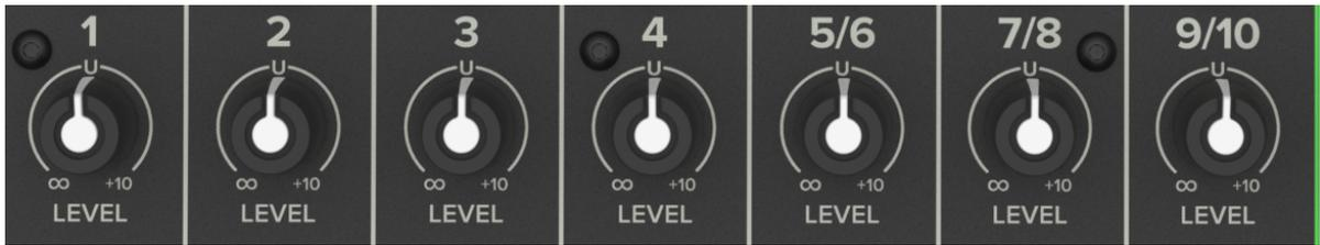
C'est le dernier réglage dans le trajet du signal d'une voie, et il ajuste le niveau de chaque voie dans le mix principal. Le marquage "U" indique un gain unitaire, c'est à dire qu'il n'y a ni augmentation ni diminution du niveau du signal. Au maximum, il fournit un boost de 10 dB si tu as besoin d'amplifier une section d'un morceau. Si tu constates que le niveau global est trop bas ou trop élevé avec le niveau proche de l'unité, vérifie que le réglage du gain est correct.
