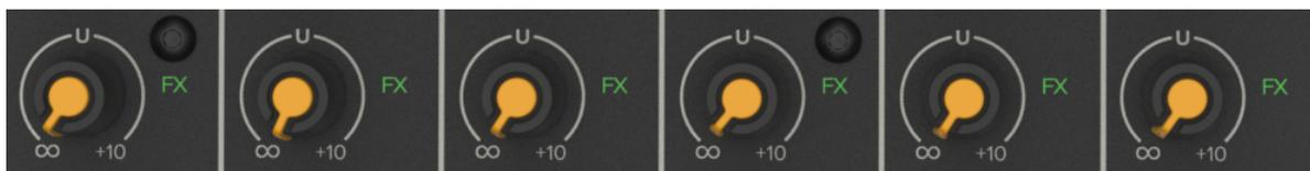
Ces réglages permettent de prélever une portion du signal de chaque canal pour créer un mix d'effets qui alimente le processeur d'effets interne et pour envoyer le signal vers des processeurs externes via l'envoi d'effets (FX send).
