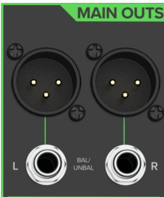
Les sorties principales portent le signal niveau ligne du mixage stéréo final. Connecte-les aux entrées gauche et droite de ton amplificateur de puissance principal, de tes enceintes actives ou d'un processeur d'effets en série (comme un égaliseur graphique ou un compresseur/limiteur).
