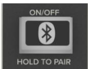
Les consoles de mixage ne peuvent accepter qu'une seule source d'entrée par voie, et la ProFXIO GO ne fait pas exception. Ce commutateur active le mode de jumelage de la voie, permettant à la console de mixage d'être détectée par d'autres appareils Bluetooth, comme un téléphone ou une tablette.
