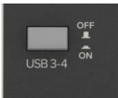
Lorsque ce bouton est enfoncé, le signal des voies 7/8 est remplacé par le signal USB – lecture stéréo depuis Spotify® ou un DAW via la connexion USB, par exemple. Comme pour toute autre entrée, ce signal peut également être égalisé ou mélangé avec les autres signaux et assigné aux sorties principales.
