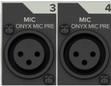
Ce connecteur XLR femelle accepte les signaux micro ou ligne symétriques en provenance de quasiment n'importe quelle source. Ces préamplis micro offrent une fidélité et une marge dynamique dignes des meilleurs préamplis autonomes du marché. Ils sont également très efficaces pour rejeter les parasites et le bruit.
