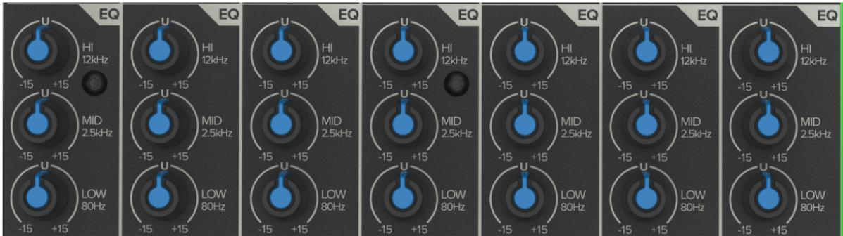
La console ProFXIO GO est équipée d'un égaliseur 3 bandes, avec un réglage de graves et d'aigus en mode shelving et un réglage de médiums en mode peaking. Les fréquences sont les suivantes : graves en shelving à 80 Hz, médiums en peaking à 2,5 kHz et aigus en shelving à 12 kHz.
