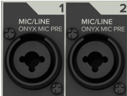
Les canaux d'entrée 1 et 2 sont équipés d'un connecteur XLR symétrique compatible avec les signaux niveau micro ou ligne. Ils sont câblés ainsi, conformément aux normes spécifiées par l'AES (Audio Engineering Society).
