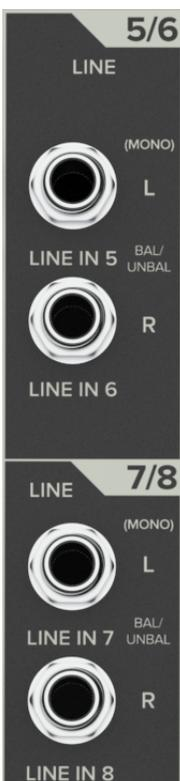
Les entrées ligne stéréo sont conçues pour des signaux symétriques via Jack 6,35 mm TRS ou asymétriques via Jack 6,35 mm TS. Elles peuvent recevoir n'importe quelle source au niveau ligne : instrument, effet, lecteur CD, etc.
