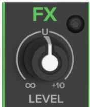
Ce bouton permet de régler le niveau général des effets juste avant qu'ils ne soient transmis aux sorties FX. Les signaux stéréo passent par ce réglage FX puis continuent vers le réglage du mix principal. Ils contiennent les signaux "wet" (traités) des effets et sont mélangés aux signaux "dry" (originaux) des voies. Au maximum, ce réglage ajoute 10 dB de gain supplémentaire ; la marque "U" correspond au gain unitaire, et au minimum, les effets sont coupés.
