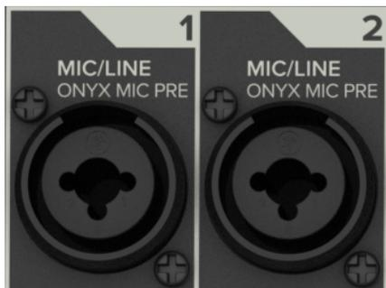
Los dos primeros canales de entrada pueden aceptar una señal de nivel de micro o de línea balanceadas a través de un conector XLR. Estas tomas están cableadas de la siguiente forma, de acuerdo a los standards especificados por la AES (Audio Engineering Society).
