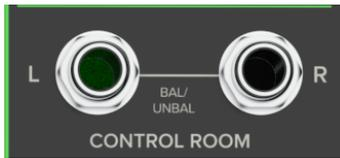
Habitualmente conectarás estas tomas de 6,35 mm a las entradas de un amplificador de la sala de control o a un amplificador de distribución de auriculares.
