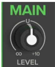
Este mando stereo te permite ajustar los niveles de las señales de mezcla principal enviadas a las salidas de nivel de línea principales XLR y de 6,35 mm.
