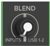
Con el interruptor adyacente (To Phones / Control Room) activado, este mando te permitirá enviar una mezcla entre todas las entradas (excepto la entrada de 3,5 mm) y el retorno USB 1-2 a las salidas de auriculares y de sala de control. Y como bonus añadido, ¡es completamente sin latencia!
