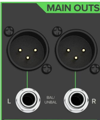
Las salidas principales te ofrecen una señal de nivel de línea que representa el final de la cadena de señal del mezclador, allí donde toda la señal stereo mezclada se cruza con el mundo real. Conecta estas tomas a las entradas izquierda y derecha de tus etapas de potencia, altavoces autoamplificados o procesadores de efectos en serie (como puede ser un ecualizador o un compresor/limitador).
