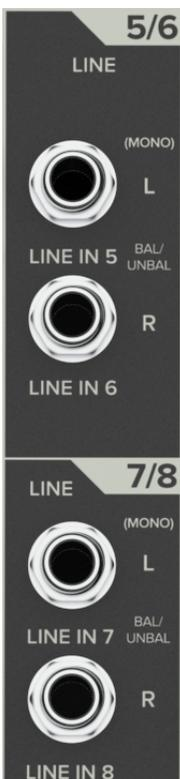
Las entradas de línea stereo han sido diseñadas para recibir señales balanceadas en TRS de 6,35 mm y señales no balanceadas en TS de 6,35 mm.
