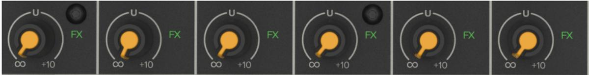
Estos mandos capturan una parte de la señal de cada canal para reunir una preciosa mezcla FX que es pasada al procesador de efectos interno, así como para dar señal a procesadores externos a través del envío de efectos.
