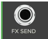
Puedes usar esta salida de nivel de línea en TRS de 6,35 mm para dar señal a un procesador de efectos (FX) externo, como por ejemplo a un curioso efecto de sonido o una unidad de retardo. La salida de esta toma es una copia exacta de la que es enviada al procesador FX interno; es decir, la cuidada mezcla de todos los canales cuyo control Aux FX hayas ajustado a alguna posición superior al mínimo.
