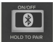
Los mezcladores no solo pueden aceptar una entrada por canal, y el ProFXIO GO no es distinto tampoco en eso. Este interruptor activará el modo de apareamiento de canal, que permitirá que el mezclador sea detectado por otros dispositivos Bluetooth como puede ser un móvil o una tableta.
