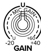
Bei Monokanälen (Mikrofoneingang mit Mono Line-Eingang) stellt der Gain-Regler die Eingangsempfindlichkeit der Mikrofon- und Line-Eingänge ein.
