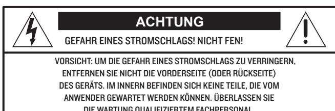
Der Blitz mit Pfeilspitze im gleichseitigen Dreieck soll den Anwender vor Nichtisolierter "gefährlicher Spannung" im Geräteinnern warnen. Diese kann so hoch sein, dass die Gefahr eines Stromschlags besteht.
