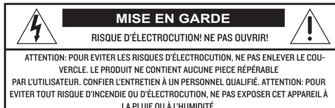
Le symbole de l'éclair à l'intérieur d'un triangle équilatéral est utilisé pour alerter l'utilisateur de la présence "tensions dangereuses" non isolées à l'intérieur du produit, et de potentiel suffisant pour constituer un risque sérieux d'électrocution.
