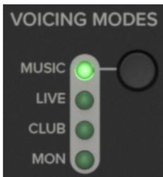
Der Voicing-Modus ermöglicht es dir, das Voicing des Thump zu ändern, um es optimal an deine Anwendung anzupassen. Drücke die Taste für den Voicing-Modus so oft, bis die LED des gewünschten Voicing-Modus leuchtet.
