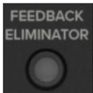
Der Multiband-Feedback Eliminator spürt störende Rückkopplungsfrequenzen auf und wendet automatisch bis zu sechs Notch-Filter (Kerbfiler) an, um Feedback zu unterdrücken und die Verstärkung vor dem Feedback zu maximieren. Dies ist ein großartiges Werkzeug, wenn kein Techniker anwesend ist.
