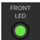
Am unteren vorderseitigen Rand jedes ThumpXT befindet sich eine einzelne horizontale LED. Diese LED leuchtet grün, wenn die vordere LED-Taste aktiviert ist. Außerdem leuchtet die LED der Taste grün. Deaktiviere die Taste, wenn du nicht möchtest, dass die LED auf der Vorderseite leuchtet. Wir nennen dies den „Tarnkappen“-Modus.
