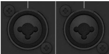
Die Eingangskanäle 1 und 2 können ein symmetrisches Mikrofonsignal über einen XLR-Anschluss verarbeiten.
