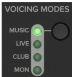
I modi Voicing ti consentono di modificare il suono del Thump per adattarlo al meglio per la tua applicazione specifica. Premi ripetutamente il pulsante del modo Voicing finché non si illumina il LED del modo Voicing che desideri.
