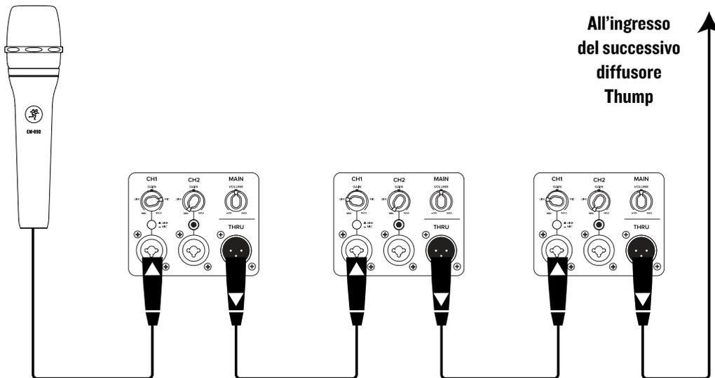
I diffusori ThumpXT possono essere collegati in serie tramite la presa "THRU", uscita di tutti gli ingressi. Basta collegare la sorgente di segnale (p.es.: uscita del mixer output o microfono) nella/e presa/e di ingresso e collegare il THRU di quel diffusore alla presa di ingresso del successivo e così via, collegando fra di loro più diffusori ThumpXT. Sopra c'è la rappresentazione grafica del collegamento in serie.
