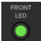
In basso sul frontale del ThumpXT c'è un LED unico. Questo LED si illumina verde quando l'interruttore del LED anteriore è attivo. Inoltre si illumina verde anche il LED dell'interruttore. Se non vuoi che il LED anteriore si illumini basta disattivare l'interruttore. Ci piace chiamarlo modo 'stealth'.
