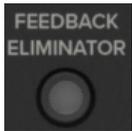
El supresor de realimentación multibandas se ocupa de localizar las frecuencias de realimentación problemáticas y aplica automáticamente hasta seis filtros de muesca para eliminar la realimentación y maximizar la ganancia previa. Esto es una herramienta perfecta cuando no tengas a mano un técnico de sonido.
