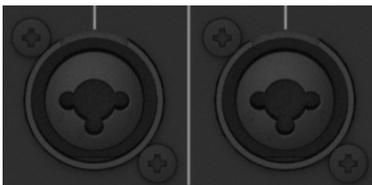
Los canales de entrada 1 y 2 pueden aceptar una señal de micro balanceada a través de un conector XLR.
