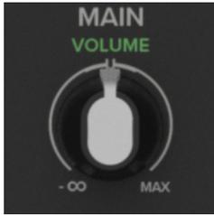
Este mando de volumen ajusta el nivel global de la señal en la entrada de las etapas de potencia internas. Su rango va desde Off (-∞) a MAX (ganancia máxima).
