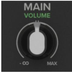
Le réglage de volume permet d'ajuster le niveau global du signal à l'entrée des amplificateurs de puissance intégrés. Il va de  $-\infty$  (minimum) jusqu'à MAX (gain maximum).
