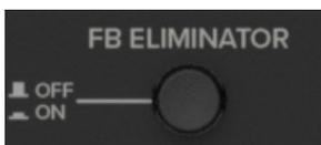
L'éliminateur de larsen multi-bandes traque les fréquences responsables du larsen et applique automatiquement jusqu'à six filtres coupe-bande pour éliminer le larsen et maximiser le gain. C'est un outil très utile lorsque l'ingénieur du son n'est pas présent.
