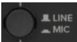
Dato che al connettore XLR puoi collegare un microfono o uno strumento, questo interruttore regola la sensibilità di ingresso del canale per ottimizzare il canale I per segnali microfonici o linea. Se colleghi un microfono, questo interruttore dovrebbe essere premuto e la manopola Gain (leggi sotto) impostata su MIC. Se tramite XLR colleghi uno strumento al canale I, questo interruttore deve essere disattivato e la manopola Gain impostata su LINE.
