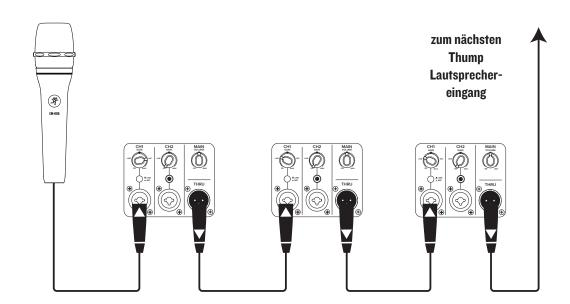
Thump-Lautsprecher können über die "THRU"-Buchse, die alle Eingänge ausgibt, verkettet werden. Schließe einfach die Signalquelle (z.B. den Mixerausgang oder das Mikrofon) an die Eingangsbuchse (n) an und verbinde die THRU-Buchse dieses Lautsprechers mit der Eingangsbuchse des nächsten Lautsprechers usw., um mehrere Thump-Lautsprecher zu verketten. Siehe oben die visuelle Darstellungen der Verkettung.
