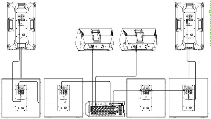
Jetzt richten wir ein großes Clubsystem ein. In diesem Beispiel sind die L/R-Ausgänge eines DLI6S-Mixers direkt mit den Eingängen von Kanal A eines ThumpII8S Subwoofer-Paares verbunden. Der Full Range-Ausgang jedes Subwoofers wird dann mit den Eingängen eines weiteren Paares von ThumpII8S-Subwoofern verbunden.
